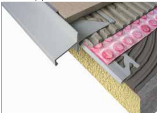
15. Detail montáže profilu H14 a odvodnenia systému pomocou rohože KD 5 a PVC distančného profilu k H14
